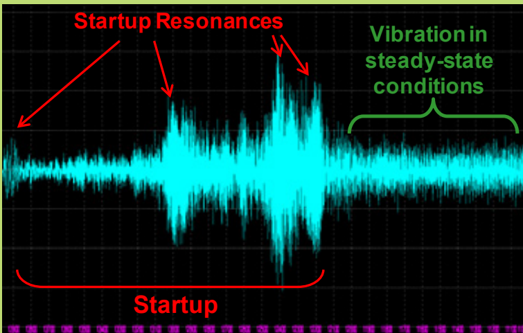
Accelerazione verticale vs. tempo durante l'avvio della macchina Vertical acceleration vs. time during machine startup
